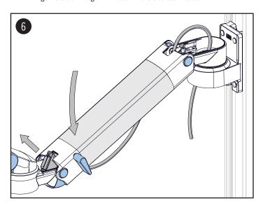
8. Ab dieser Stelle haben Sie zwei Möglichkeiten die Kabel herauszuführen: **OPTION A:** durch das vordere Dreh-/ Neigelager (Abb. 8.A) oder **OPTION B:** unterhalb des vorderen Dreh-/ Neigelagers (Abb. 8.B).
