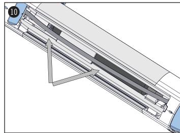
11. Montieren Sie den Kunststoffdeckel am vorderen Dreh-/ Neigelager mittels der (4) M4x8 Linsenskopfschrauben. Anschließend verschrauben Sie den Aluminiumdeckel am hinteren Schwenklager mit den (3) M5x16 Zylinderkopfschrauben und ziehen diese fest an.
