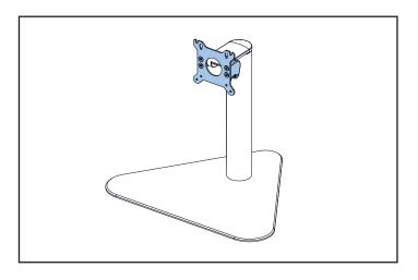
Verschrauben Sie den Tischträger mit den drei beiliegenden M5x16 Senkkopfschrauben auf der Bodenplatte bzw. auf der vorhandenen Tisch- oder Ablagefläche.
