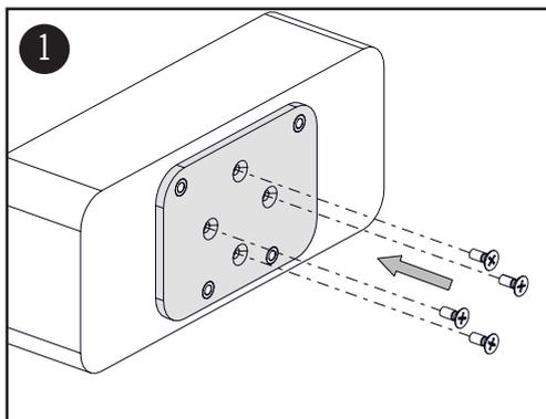
Verschrauben Sie die Adapterplatte mit dem ME-Gerät. Verwenden Sie hierfür die (4) M4x10 Senkkopfschrauben.
