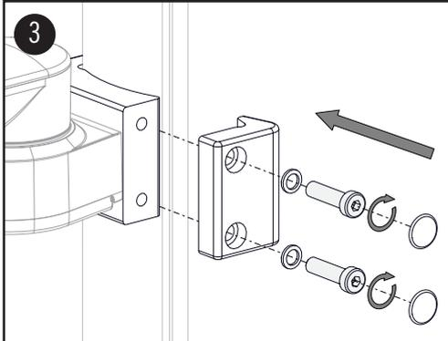
Die Normschienenklemme an die Normschiene anlegen und mit den (2) M8 Schrauben (Innensechskant) befestigen.
