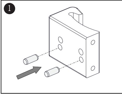
Zylinderstifte in die unteren Bohrungen stecken.
