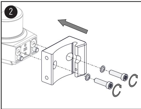
Den Adapter an der Konsole mit den 2 x M8 Schrauben (TX45) und den beiden Sperrkantscheiben festziehen.
